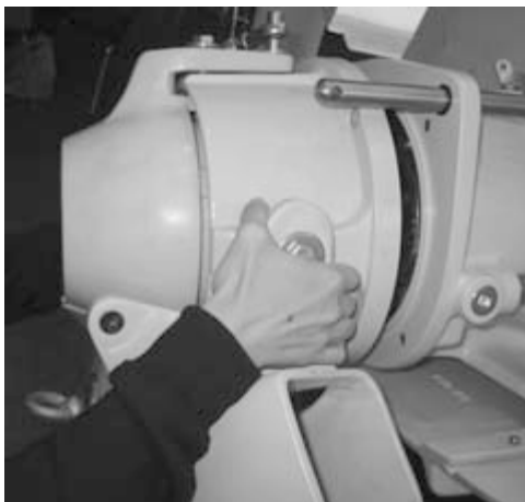
Kuva 64. Staattorin vetäminen pois
