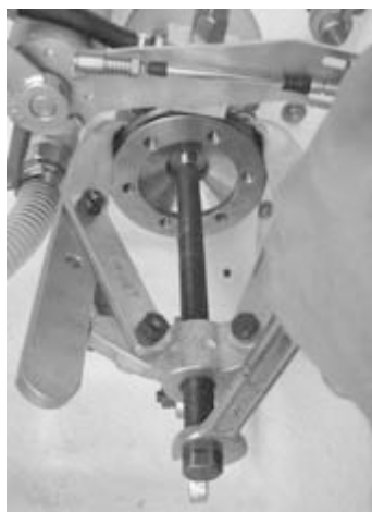
Kuva 3. Vetolaipan irrotus ulosvetäjällä
